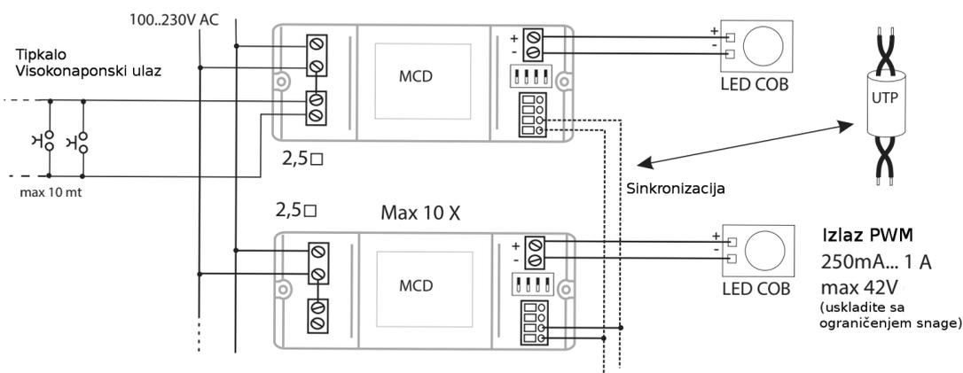
Pri nestanku mrežnog napna driver će zapamtiti zadnje podešeno stanje intenziteta svjetla. Ako dodajete više drivera paralelno potrebno ih je sinkronizirati. Da bi ih sinkronizirali pritisnite Tipkalo i držite 15 sekundi.
