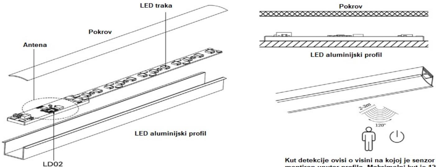
Kut detekcije ovisi o visini na kojoj je senzor montiran unutar profila. Maksimalni kut je 120°
